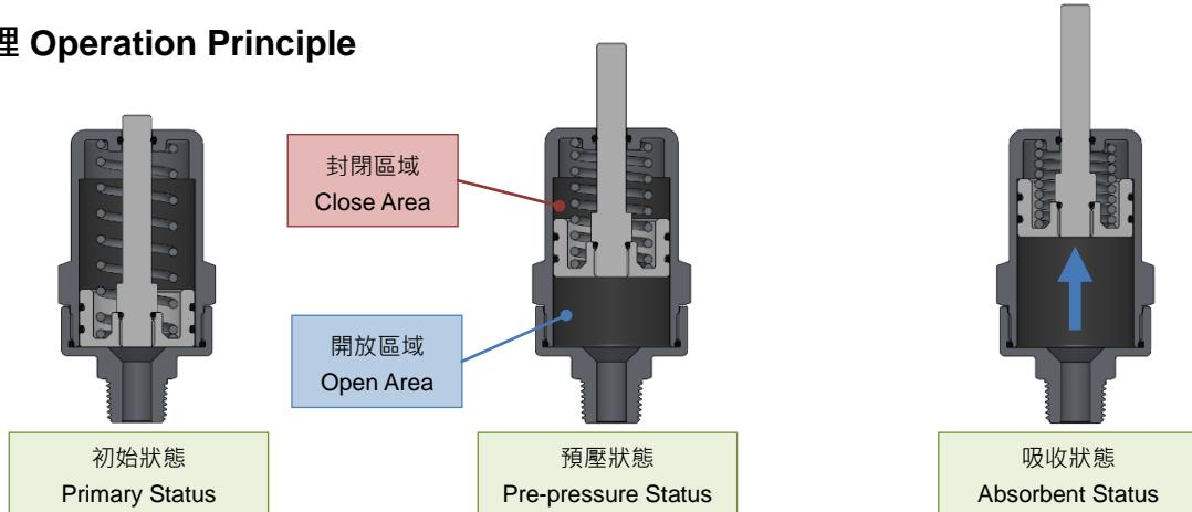
防水錘閥是圓柱體外形，內部減震活塞有雙密封 O 形環將空間劃分為兩區域，其中封閉區域有空氣及彈簧，為壓縮減震緩衝區；開放區域則與管路液體壓力接觸。當水錘現象發生時，所引起的震動脈衝由封閉區的空氣及彈簧吸收補償。
