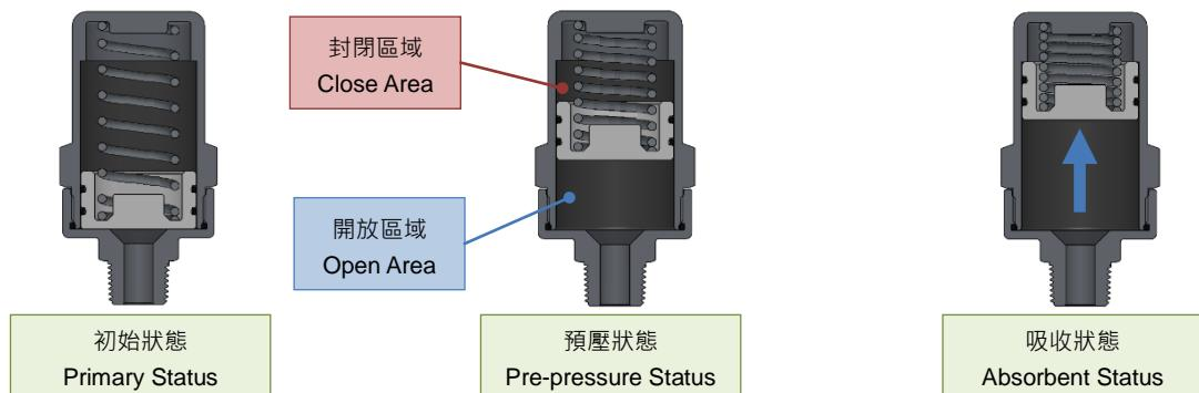
防水錘閥是圓柱體外形，內部減震活塞有雙密封 O 形環將空間劃分為兩區域，其中封閉區域有空氣及彈簧，為壓縮減震緩衝區；開放區域則與管路液體壓力接觸。當水錘現象發生時，所引起的震動脈衝由封閉區的空氣及彈簧吸收補償。
