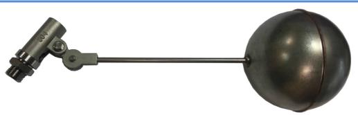
P41 型浮球閥安裝在水箱中由水面自動控制,常用於先導閥,亦可直接使用。當水箱中的水面下降時,浮球閥的連桿將隨著浮球與水面一起下降,直到浮球閥打開,讓水流入水箱。當水面緩慢增加時,浮球閥的連桿與浮球一起上升,最後關閉浮球閥,水流停止。如果浮球閥用於先導閥,則應安裝在遠離主管出口處,距離至少為 5 公尺。
