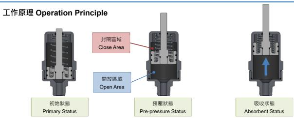
防水錘閥是圓柱體外形·內部減震活塞有雙密封 O 形環將空間劃分為兩區域·其中封閉區域有空氣及彈簧·為壓縮減震緩衝區;開放區域則與管路液體壓力接觸。當水錘現象發生時·所引起的震動脈衝由封閉區的空氣及彈簧吸收補償。
