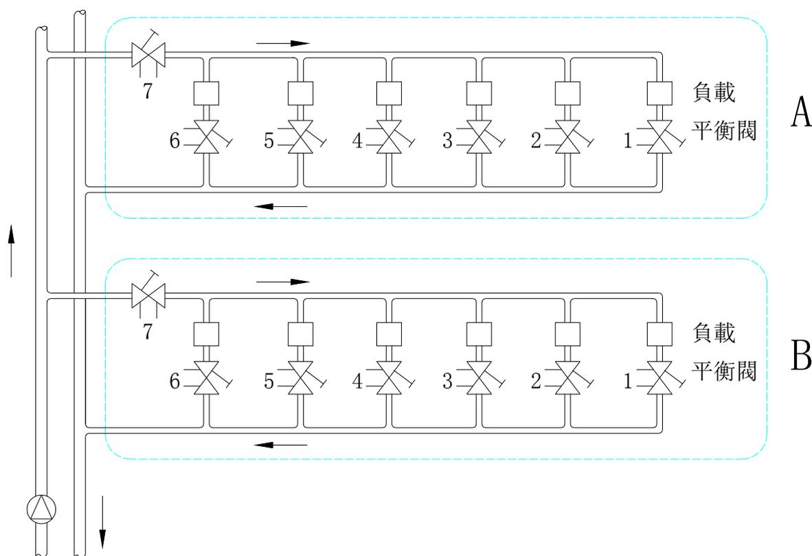
上圖即為一個空調系統的兩個模組的簡圖。圖中，可分為 A 與 B 兩個模組，A 與 B 中，各有 6 條支路，每條支路各有一個負載並各裝一顆平衡閥 1、2、……，第 7 顆平衡閥即可視為模組中的總閥，模組的最末端平衡閥 1 可視為參考閥。在調整平衡閥的比例法與補償法中，參考閥 1 調節到設計流量後，即保持不變，在調節其他閥時，參考閥 1 的流量會受到影響，這時，可調節閥 7 來維持參考閥 1 的流量不變，此為關鍵。
