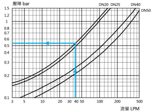
※流量曲線的靜態條件：入口壓力=8 bar，出口設定壓力=3 bar，壓降是減壓閥的設定壓力與流動壓力的差值
